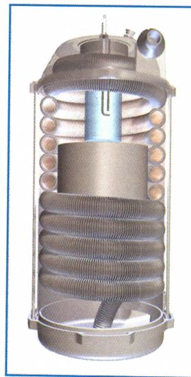
La premiscelazione controllata, in combinazione con il bruciatore a microfiamme, garantisce una perfetta combustione con una quantità minima di monossido di carbonio (CO) che non supera i 100 ppm.
